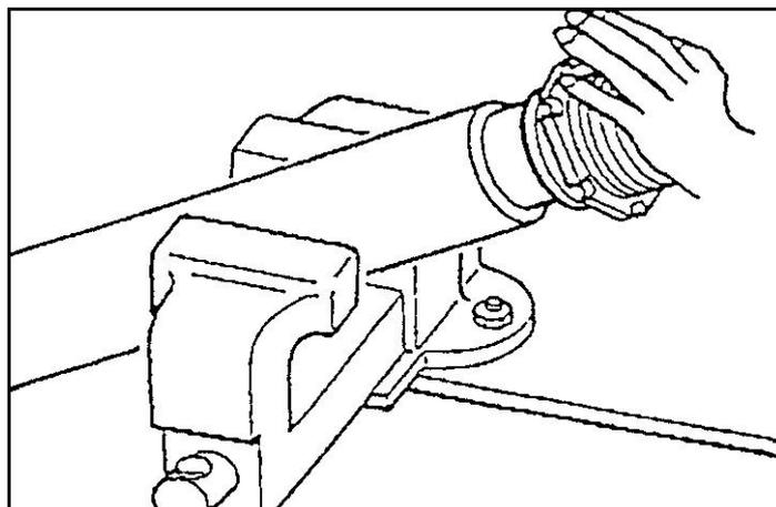
Appliquer un lubrifiant sur le bord du flexible pour faciliter l'insertion du raccord jusqu'au point de jonction.
