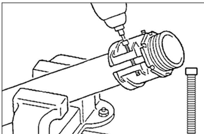
Une fois que le raccord est placé sur le tuyau, appliquer les coquilles de part et d'autre à l'aide de grandes vis.
