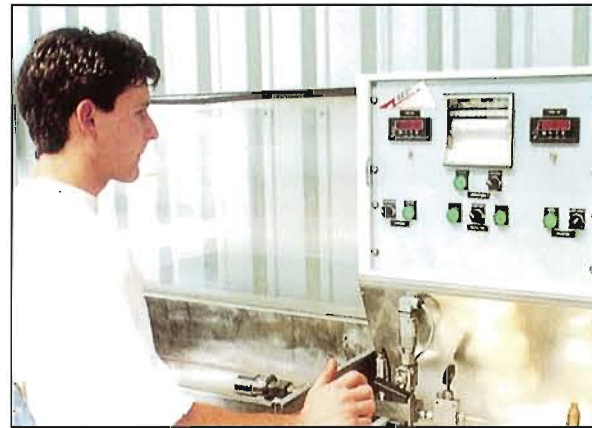
Banc d'essai de pression et de température avec tracé de courbes. Our pressure and temperature testing machine is coupled to a printer to give a graph readout of all tests conducted.
